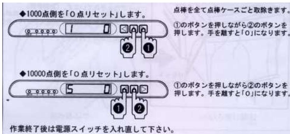
4箇所 1および5の0点リセットの作業を行いましたら、電源を OFF にします。
