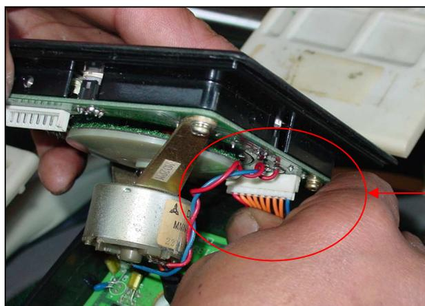
③コード9本の**根本**をしっかりと固定し、スイッチプレートを少しずつ持ち上げる様に引き抜く。
