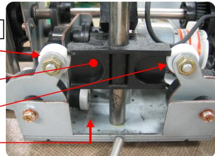
⑬取外したELスライダーのELレバーが入る部分の凹にマイラーt=0.25を貼り付けます。
