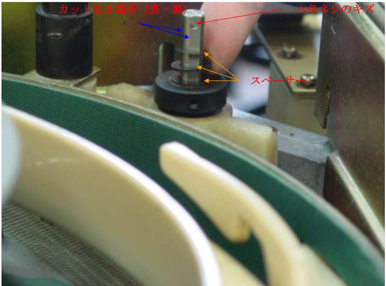
4. MGアイドラASSYの溝にMGアイドラリングの片側を入れ、指で引っ張りながら全てを溝に入れます。
