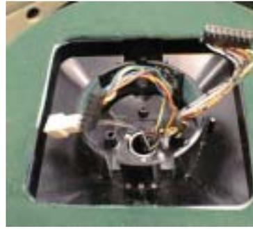
8. ボックスの下に一箇所穴がありますので、六角レンチで時計まわりの逆方向にまわしてゆるめて下さい。バネが付いている方もゆるめて下さい。
