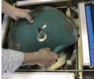
17. TTシートが外せたら、濡いたタオルなどで円盤部分を拭いて、新しいシートと交換します。
